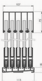
Afmetingen 5-sporige rails, verkrijgbaar in de lengte: 4900mm.
