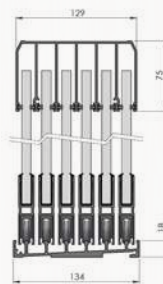
Afmetingen 6-sporige rails, verkrijgbaar in de lengte: 5900mm.
